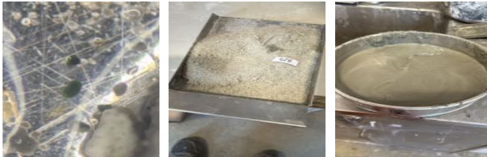
Grain de glauconite au microscope ; échantillon sec de sable glauconieux ; échantillon remonté au shaker — sable fin verdâtre caractéristique de l'Albien-Cénomanién.
